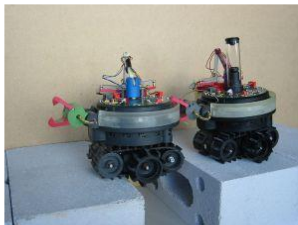
Deux robots « en essaim » ( swarm-bots ) en train de franchir un fossé. Ces robots font partie du projet européen Swarm-bots , qui s'appuie sur l'observation des sociétés d'insectes et de leur « intelligence en essaim » ( swarm intelligence ) afin de développer des objets dotés d'une capacité d'auto-organisation et d'auto-assemblage. © Projet Swarm-bots http://www.swarm-bots.org/ , avec l'aimable autorisation de Marco Dorigo.
